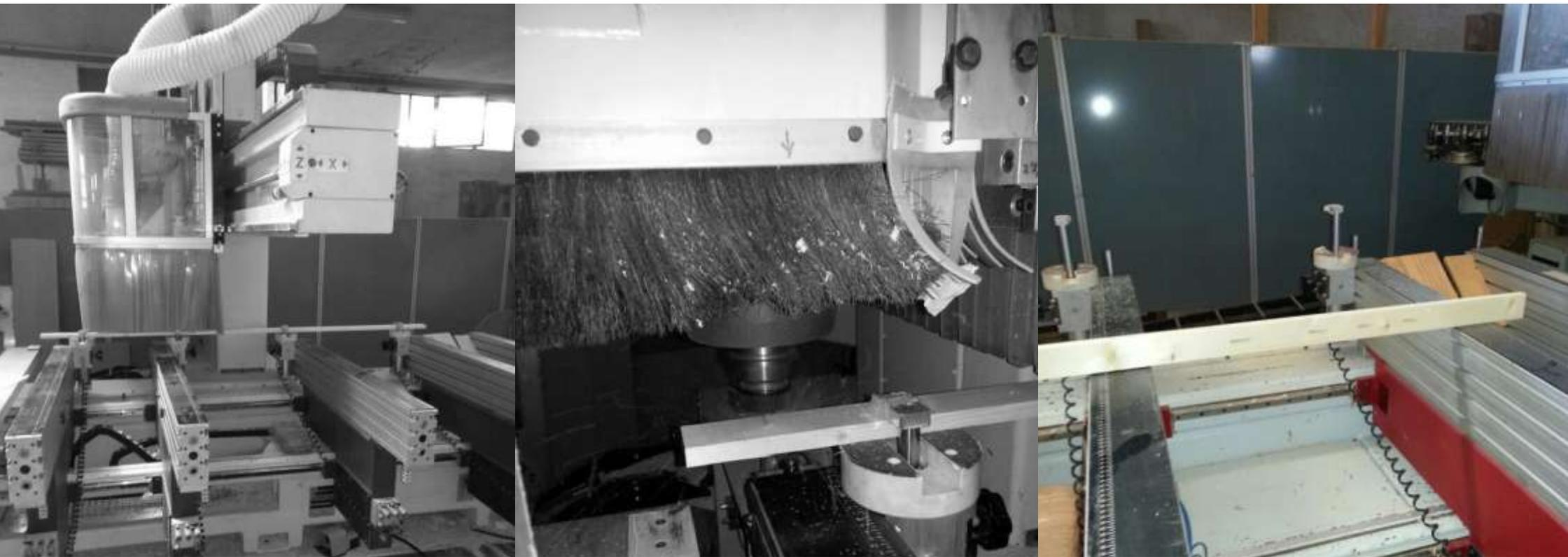
Fasi della produzione delle aste di legno utilizzate per la costruzione del 'Modulo campione' in scala 1:1
